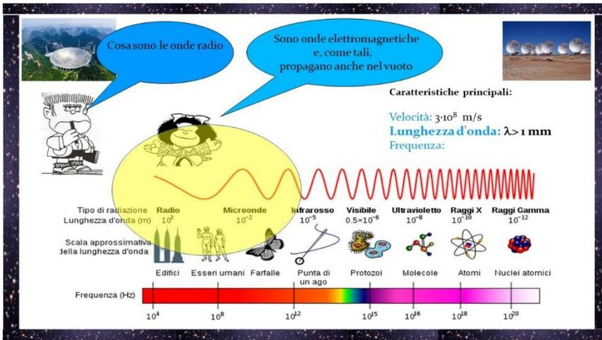
Le onde elettromagnetiche si classificano in base alla loro lunghezza d'onda, che è legata alla frequenza dalla relazione:  $\lambda f = c$  dove c è la velocità della luce.
